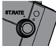
Drehen Sie den ST Rate Drehknopf gegen den Uhrzeigersinn um den Gainwert zu reduzieren.
